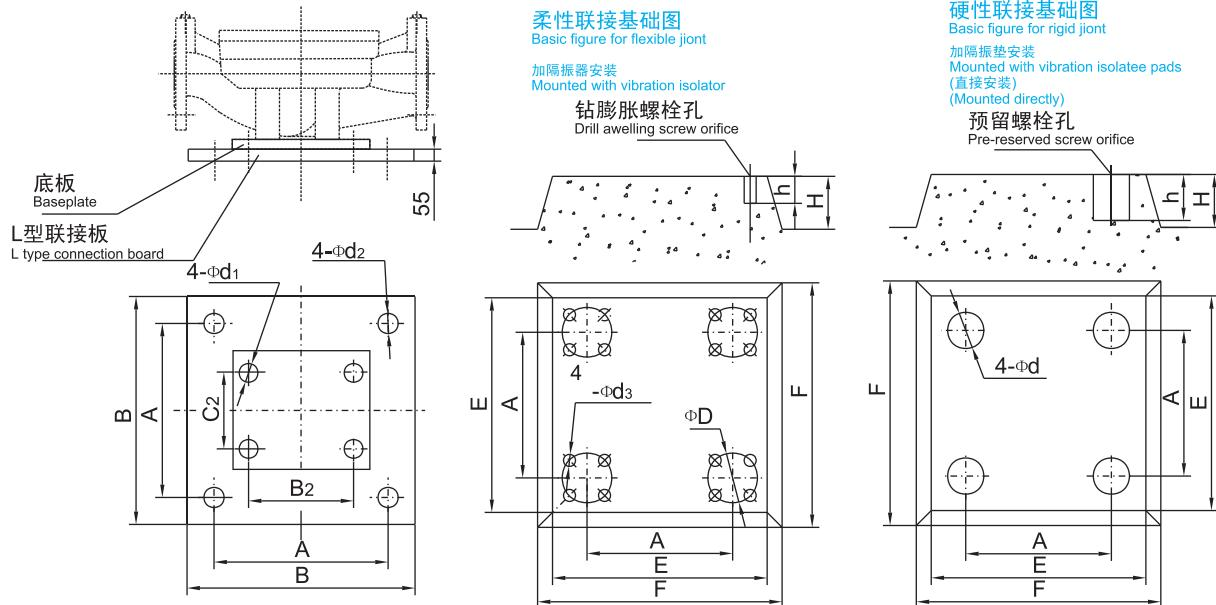
**一、底板与基础直接联接（不带L型联接板）**
